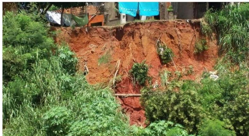
**Resumo Histórico:** Região possuindo taludes com até 8m de altura e 90º de declividade, composto por solo residual jovem e maduro, apresenta cicatrizes, depósito de escorregamento e feições erosivas como sulcos e ravinas. Também se observa trincas no terreno e árvores inclinadas. A região já foi atingida por escorregamento do tipo planar.
